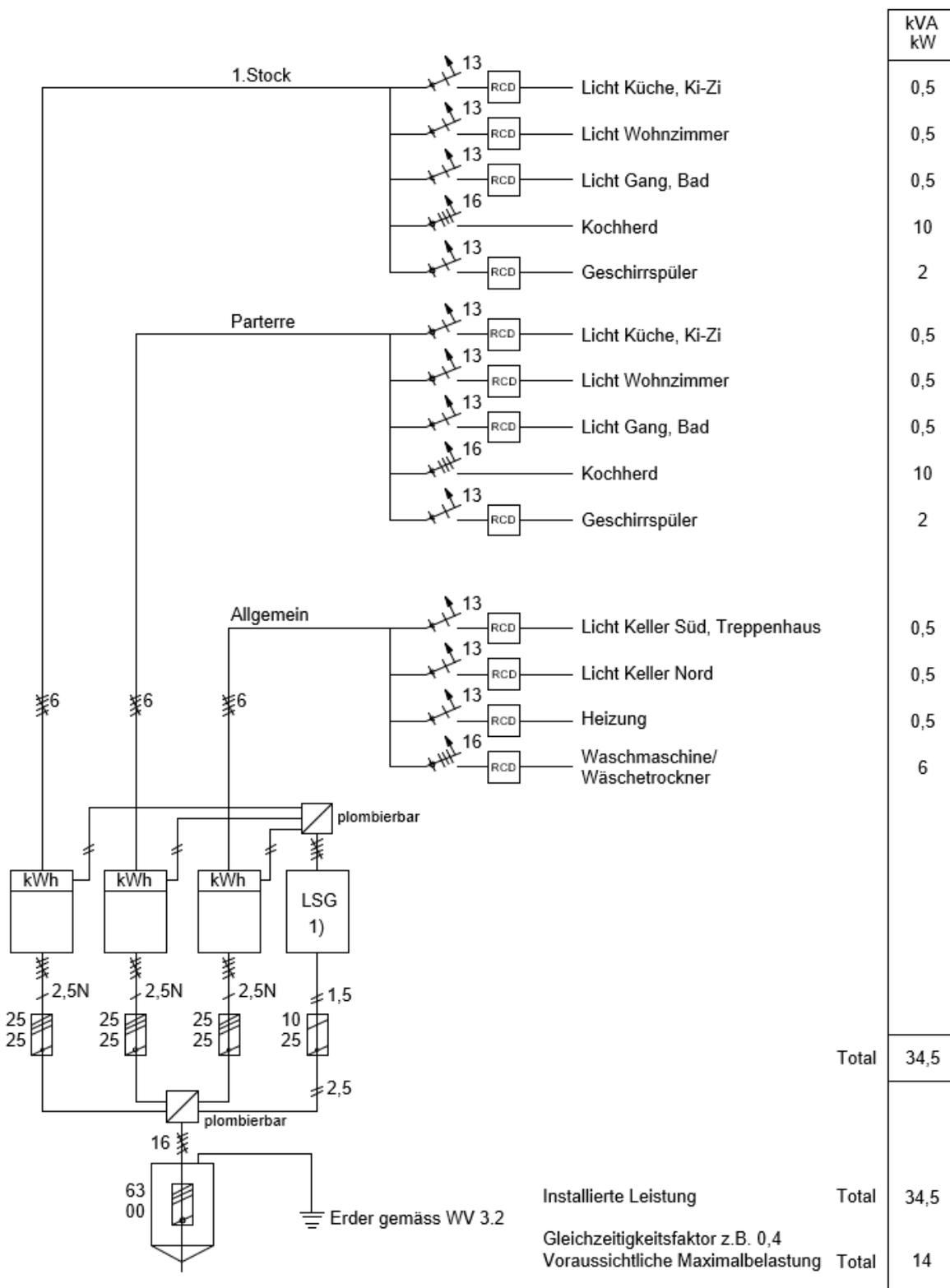
1) LSG = Lastschaltgerät oder dergleichen
