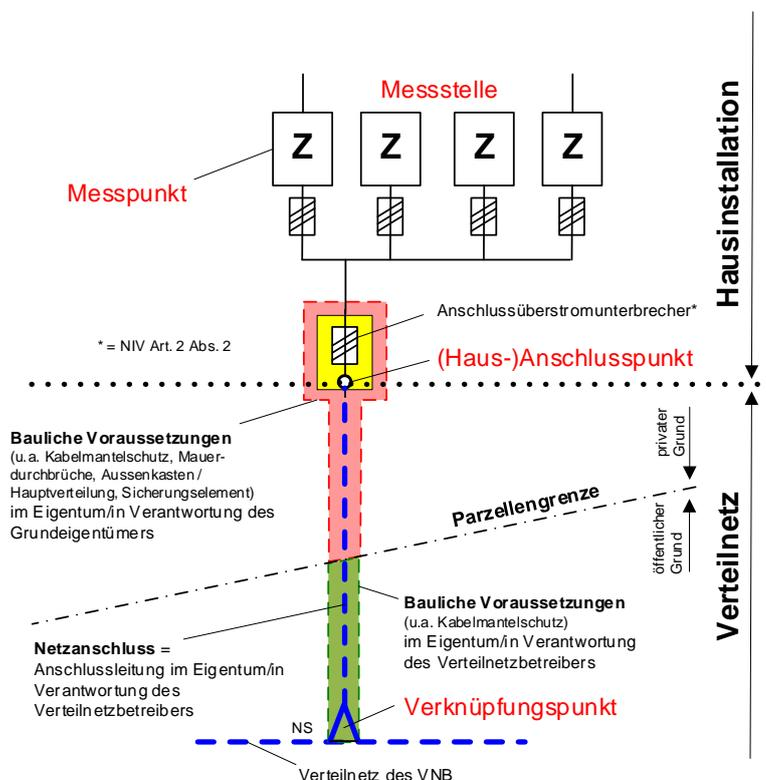
Abbildung 2: (Haus-)Anschlusspunkt und Verknüpfungspunkt
